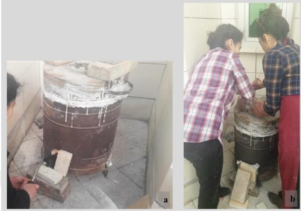
Şekil 39: Fırın yakılışı ve pişirim sürecinde hava temasının kesilmesi
