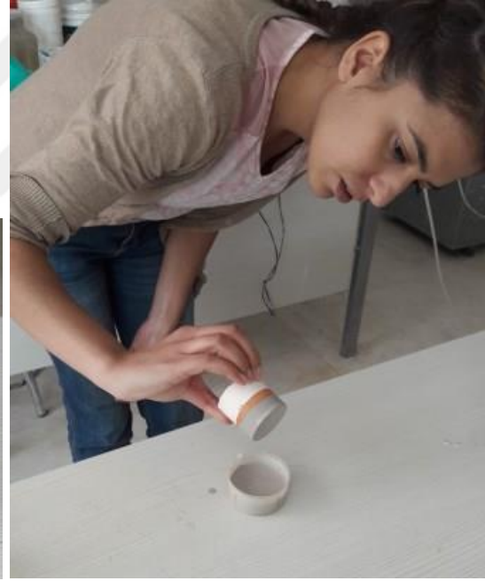
Şekil 24: Terra Sigillata örneklerin daldırma tekniği ile kaplama astarı ile kaplanması
