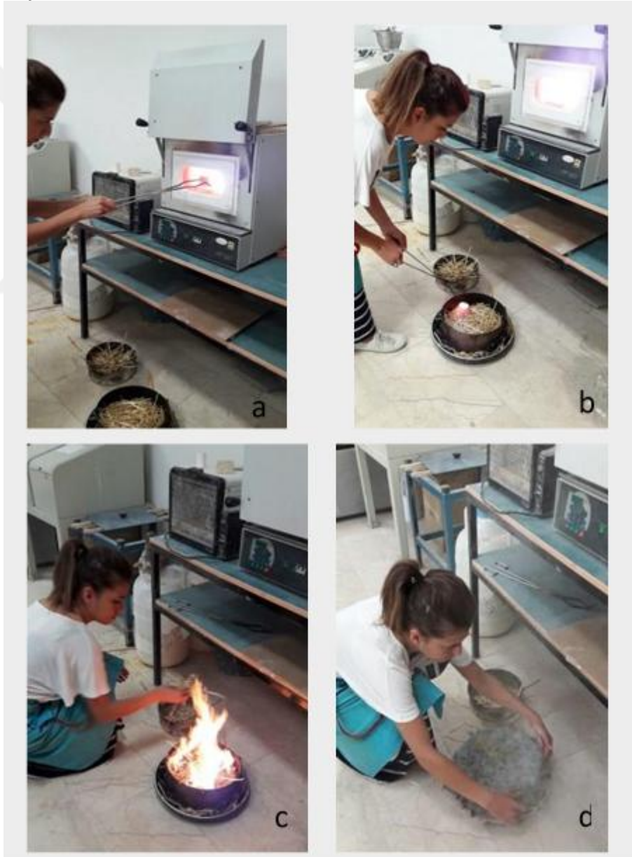
Şekil 27: Sırsız raku pişirimi sırasında ürünlerin fırından çıkarılarak yanıcı maddeler içine alınması
