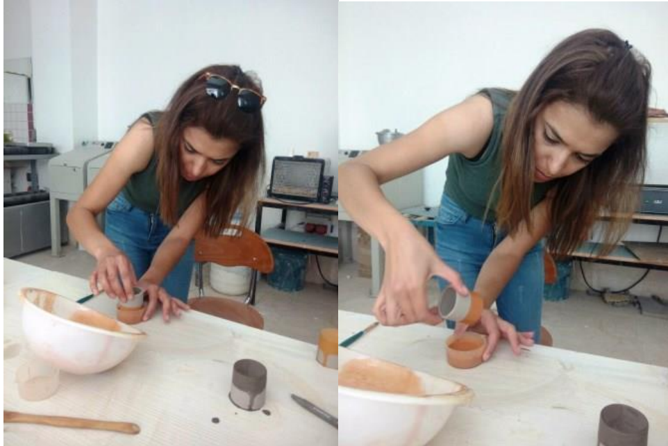
Şekil 21: Astar ve Terra Sigillataların seramik bünyeye daldırma yoluyla kaplanması
