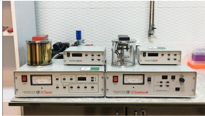
Şekil 2.5.2. Altın kaplama cihazı (Sputter Coater 108 Auto, Cressington Scientific Instruments Ltd, Watford, İngiltere)
