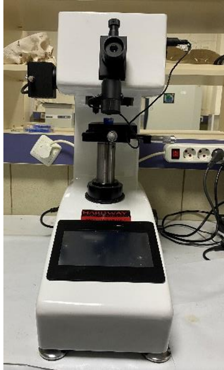
Şekil 2.8.1. Vickers mikrosertlik analiz cihazı (Hardway-mhvs 1000 AD, Çin)
