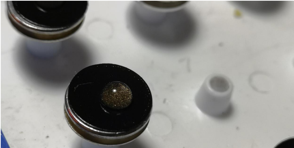
Şekil 2.3. Nanopartiküllerin elektron mikroskobunda incelenme için hazırlanması.
