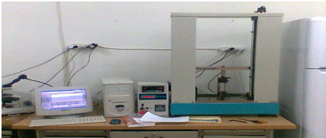
Şekil 3.7. Kullanılan çekme testi cihazı
