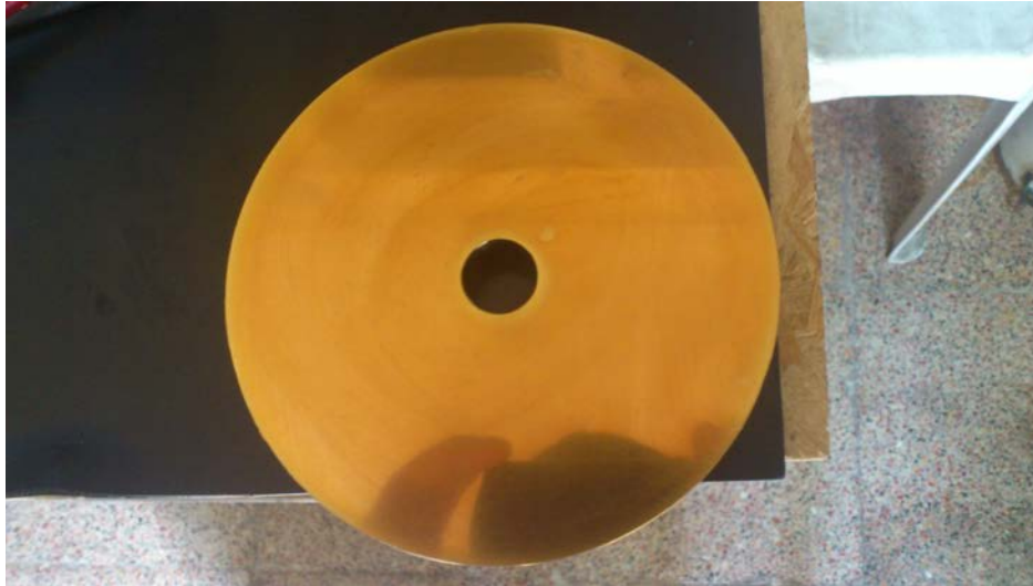
Şekil 3.2. PVD Tekniği ile TiN Kaplanmış Soğuk İş Takım Çeliği
