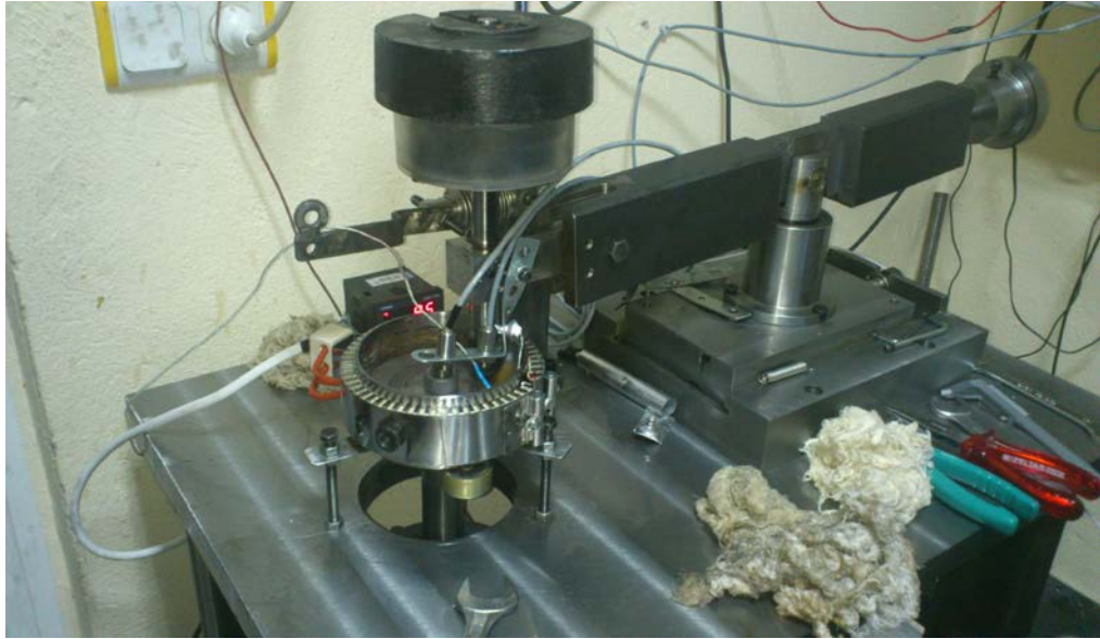
Şekil 3.4. Bilye disk deney test düzeneği
