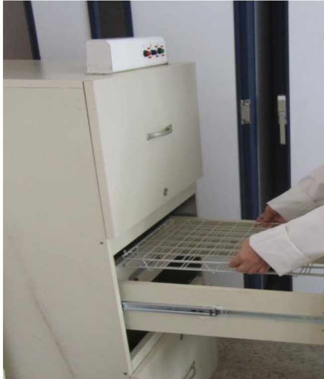
Şekil 3.2.2.2.- Işınlama kabinine kuluçkalık yumurtaların konuluşu
