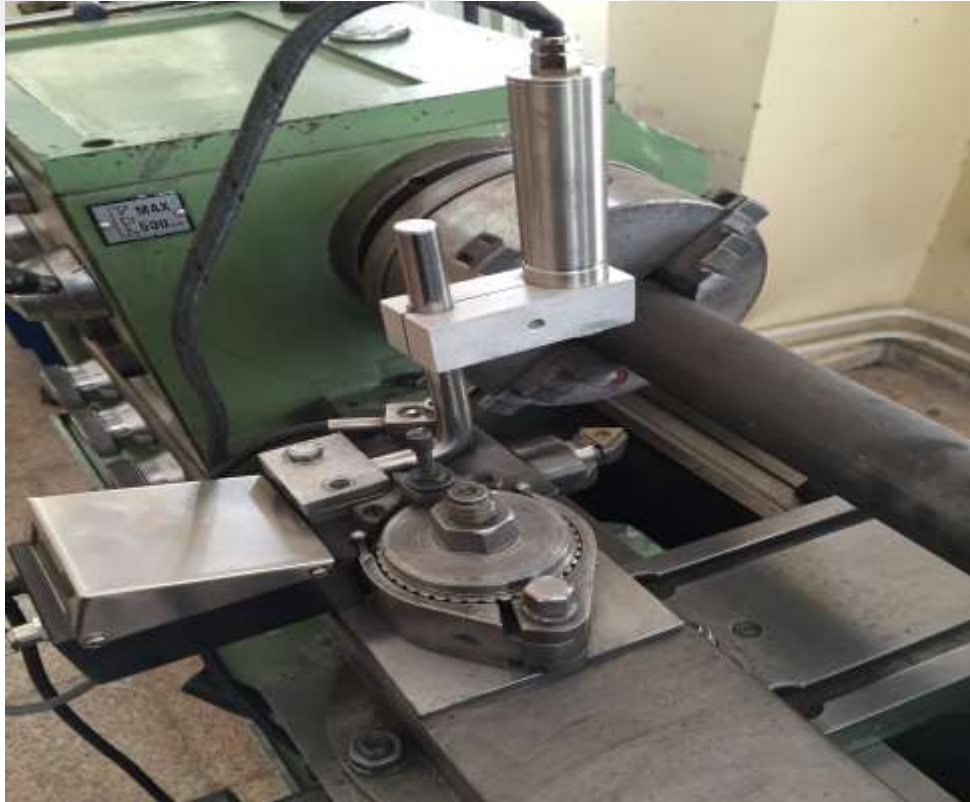
Şekil 4.4. Dinamometre, termometre ve AE sensörünün tezgaha bağlantısı
