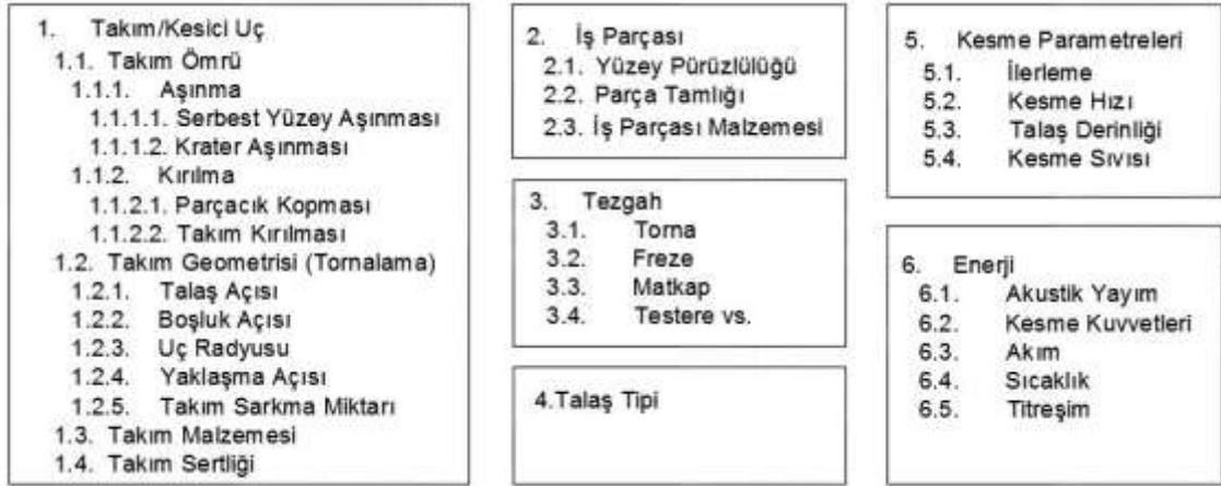
Şekil 3.5. Takım Durumu İzlemede Evrensel Olarak Kullanılan Parametreler
