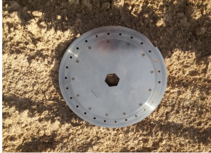
Şekil 3. 4. Seyreltmesiz ekiminin yapıldığı ekici disk
