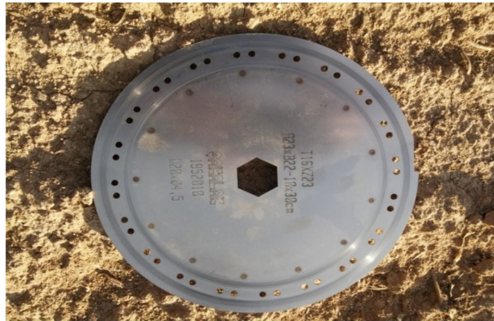
Şekil 3.5. Blok ekimin yapıldığı ekici disk
