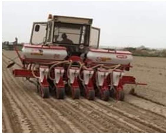
Şekil 3.1. Pnömatik hassas ekim makinesinin genel görünüşü
