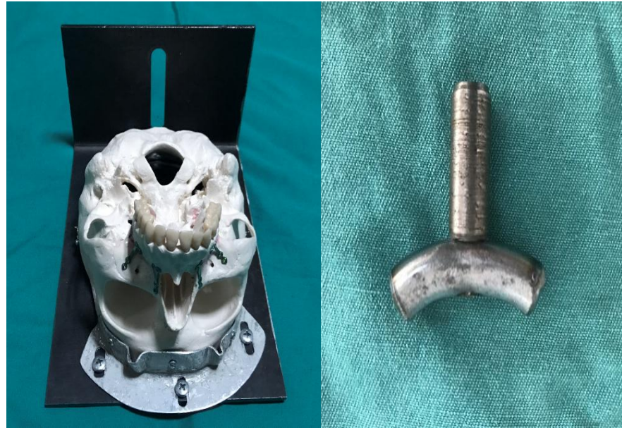
Şekil 2.7. Modelin sabitlenmesi için üretilen düzenek ve test cihazının modele kuvvet uygulaması için üretilen aparat
