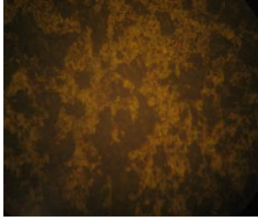
EK-3.6. 1,4 m/sn 40 N saf sertleştirilmemiş pimin aşındırıcı diskteki izi (X400)
