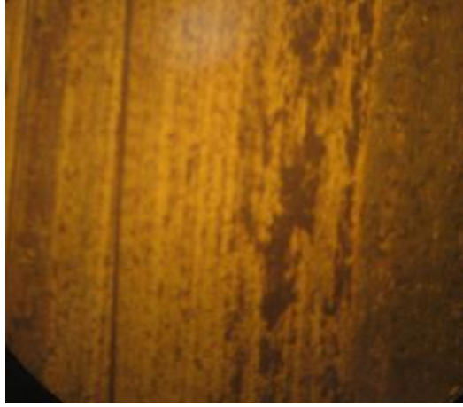
EK-3.5. 0,6 m/sn 25 N CrN/TiN pimin aşındırıcı diskteki izi (X400)
