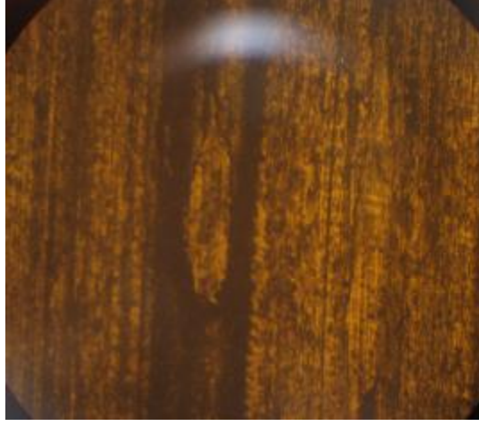
EK-3.10. 1,4 m/sn 40 N CrN/TiN pimin aşındırıcı diskteki izi (X400)
