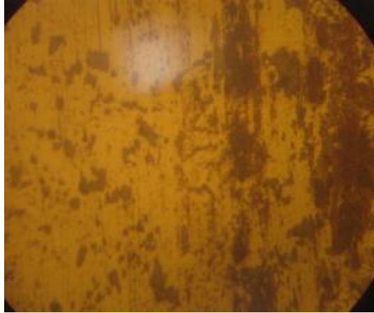
EK-3.15. 1 m/sn 55 N CrN/TiN pimin aşındırıcı diskteki izi (X400)
