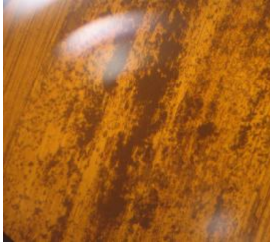
EK-3.14. 1 m/sn 55 N CrN pimin aşındırıcı diskteki izi (X400)
