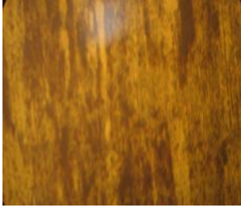
EK-3.2. 0,6 m/sn 25 N plazma nitrülenmiş pimin aşındırıcı diskteki izi (X400)
