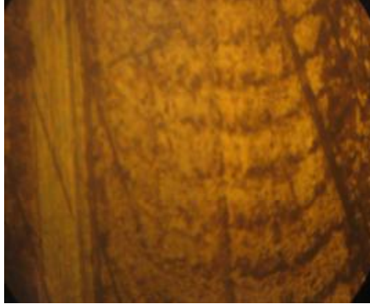
EK-3.13. 1 m/sn 55 N TiN pimin aşındırıcı diskteki izi (X400)
