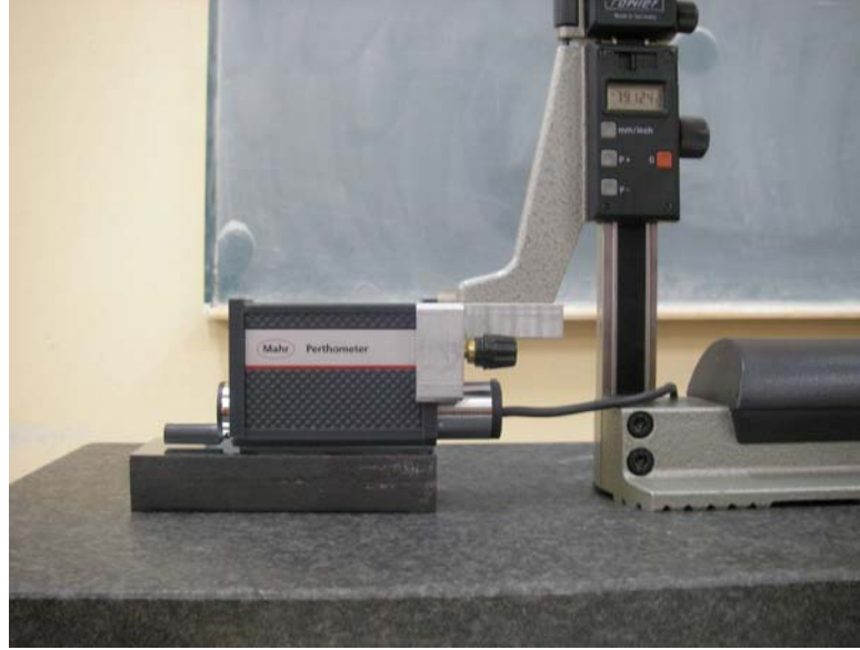
Şekil 10.6. Pürüzlülük cihazının mihengire tespiti
