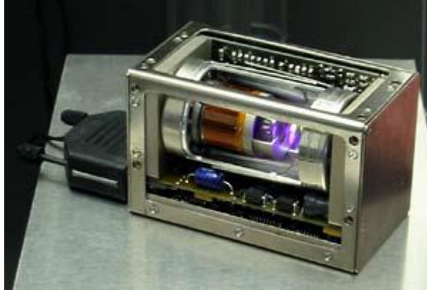
Şekil 2-3 Uydularda bulunan atom saati
