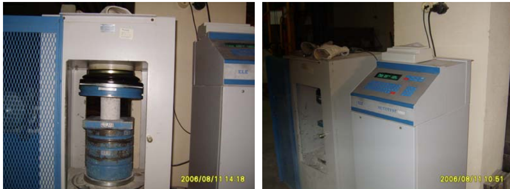
Şekil 2.6 Beton basınç deneylerinin gerçekleştirildiği pres ve deneylerin gerçekleştirilme görüntüsü
