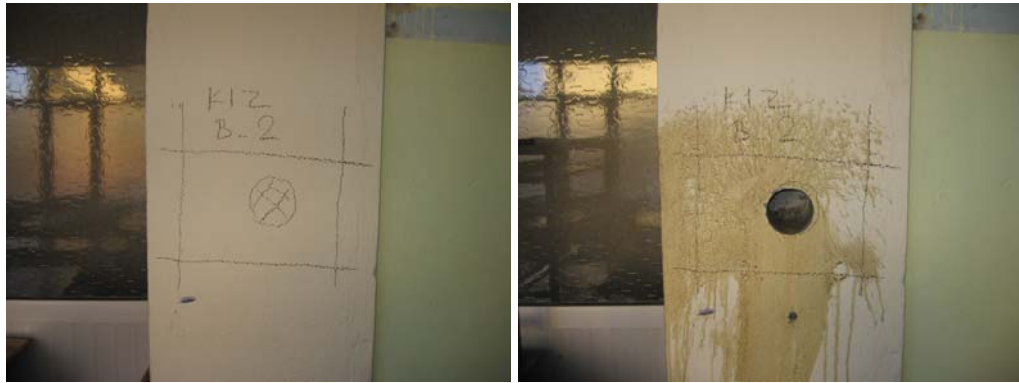
Şekil 2.5 AKML ait karot numune alımı öncesi ve sonrası görüntü
